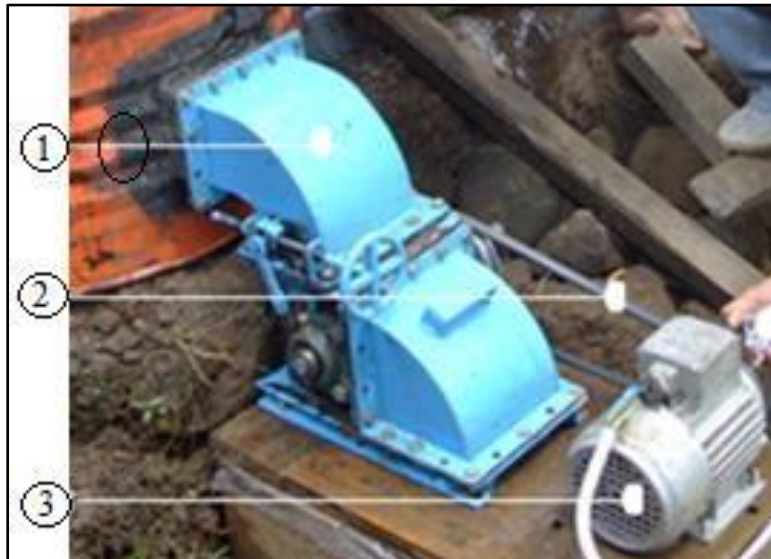
Gambar 4. Turbin Cross-flow yang Dilengkapi Dengan Transmisi Belt-Puli, dan Generator
