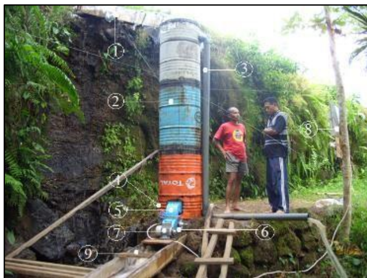
Gambar 7. Instalasi PTMPMD yang Siap Diuji
