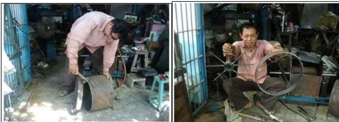
Gambar 6. Pemotongan Pipa Cincin dan Tulangan Telah Terbentuk
