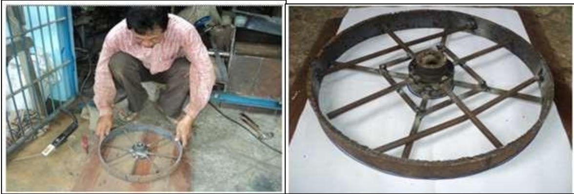
Gambar 7. Perakitan Rangka Flywheel Dan Tampilan Rangka Flywheel Selesai Dirakit
