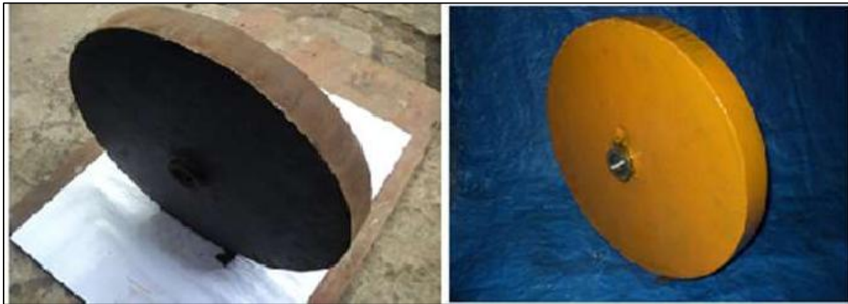
Gambar 9. Flywheel Dikeringkan dan Flywheel Setelah Dicat
