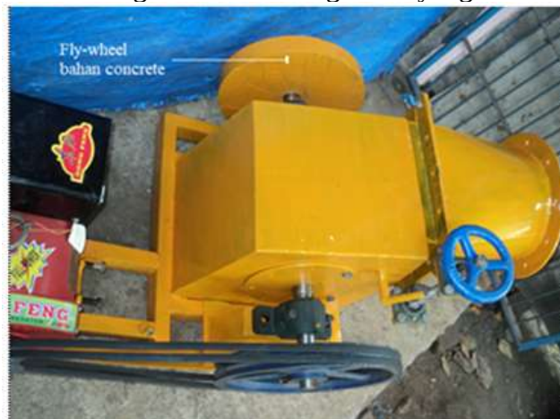
Gambar 10. Flywheel bahan beton sudah terpasang pada salah satu ujung poros turbin cross-flow
