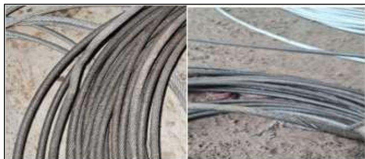
Gambar 7. Kondisi Tali Baja yang Sudah Rusak
