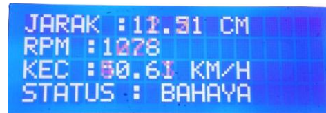
Gambar 8. Tampilan Bacaan Sensor Kecepatan
