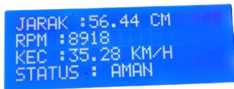
Gambar 8. Tampilan Bacaan Sensor Kecepatan
