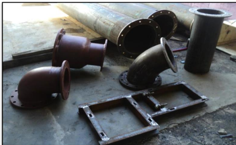
Gambar 10. Semua Komponen Bangunan Mekanikal PLTPH Selesai Dibuat Untuk Selanjutnya Akan Dilakukan Pengamplasan dan Pengecatan Dasar
