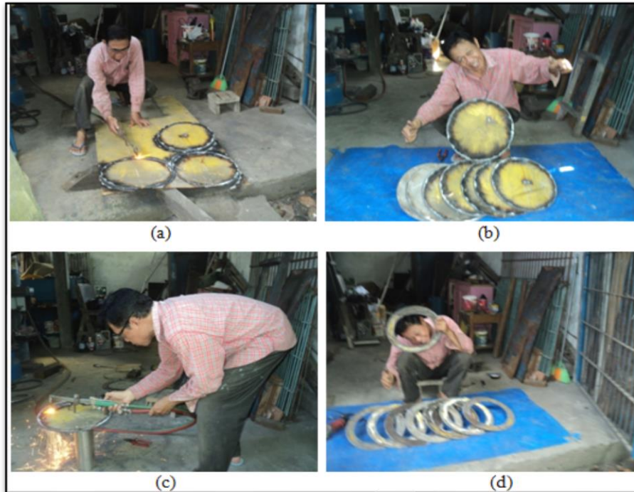
Gambar 6. Proses Pembuatan Flange Pipa Pesat, Pemotongan Melingkar Piringan Flange (a), Hasil Pemotongan Flange (b), Pemotongan Lingkaran Dalam (c), dan Flange Hasil Akhir Pemotongan Berbentuk Cincin Untuk Siap Dibersihkan-Digerinda (d)
