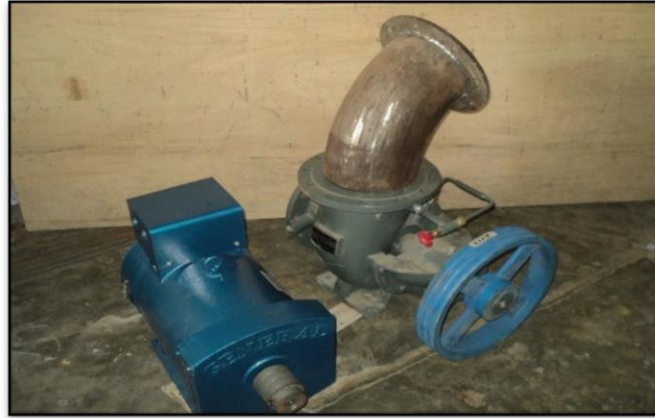
Gambar 11. Uji Keserasian Sistem Penggerak Mula, Tampak Posisi Elbow -Pompa Sebagai Turbin-Sistem Transmisi Belt-Puli, Dan Generator 5 Kw
