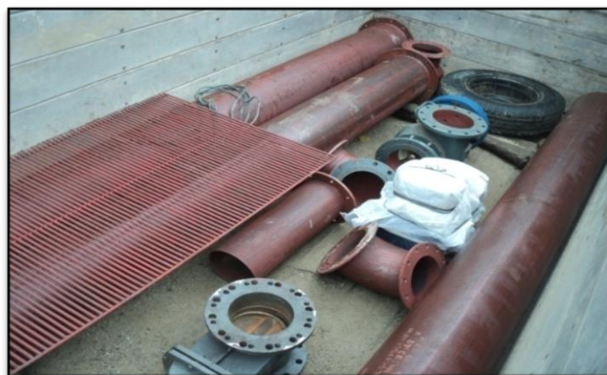
Gambar 13. Komponen Peralatan Mekanik Pembangkit Piko-Hidro Sudah Dinaikkan Ke Dalam Bak Truk, Tampak Di Antaranya Katup Gerbang, Elbow , Draft Tube , Pompa Sentrifugal, Tiga Batang Pipa Pesat, Saringan, dan Generator (Ditutup Terpal Putih)
