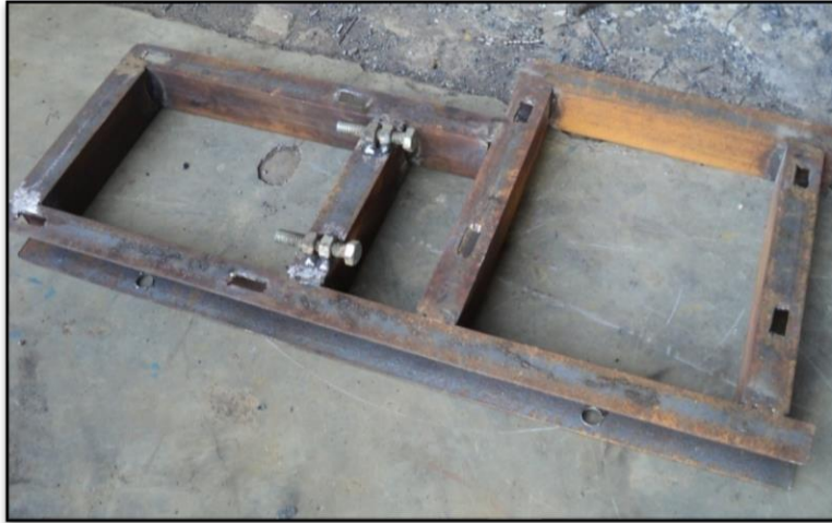
Gambar 8. Frame Atau Dudukan Pompa Sebagai Turbin-Generator Dari Bahan Baja
