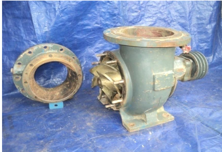
Gambar 9. Komponen utama pompa sentrifugal 8 inci
