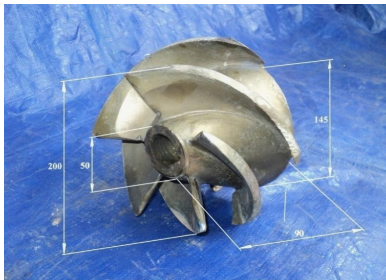
Gambar 10. Dimensi impeller pompa sentrifugal 8 inci
