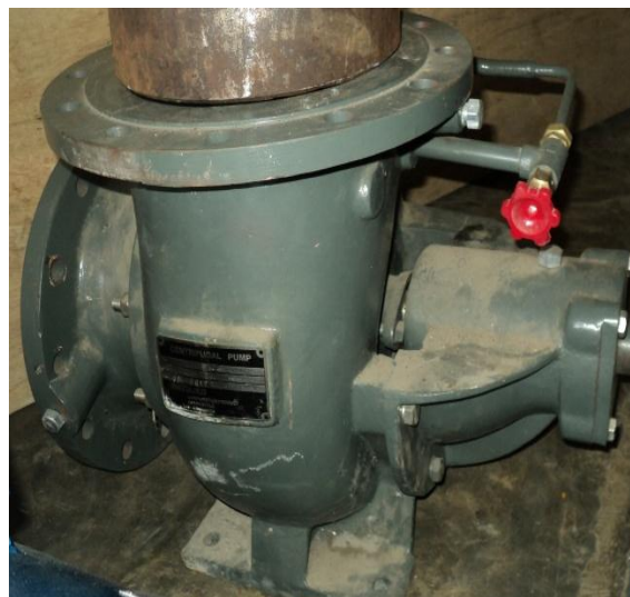
Gambar 7. Pompa sentrifugal yang dipilih sebagai penggerak mula PLTPH
