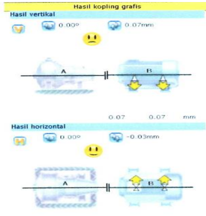
Gambar 6. Kondisi Awal (Tidak Baik)
